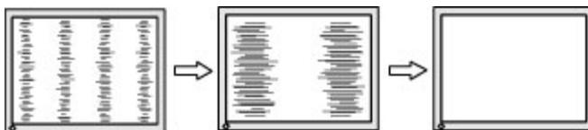
4. Dopo la regolazione dell'Orologio, in caso di sfocatura o sfarfallio o se sullo schermo appaiono delle barre, procedere alla regolazione della Fase.
