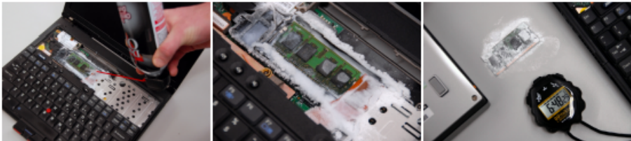
Figura 30: Dimostrazione del metodo Cold Boot RAM Extraction
