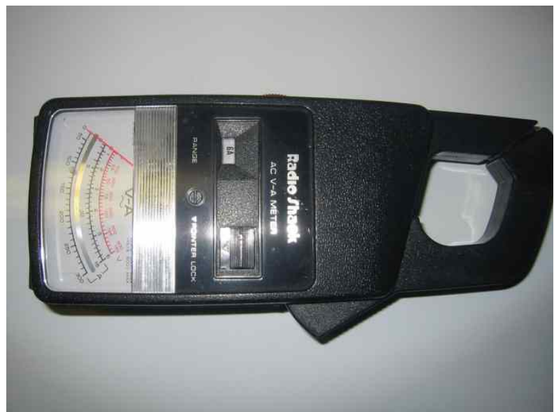
AC Amp Meter
