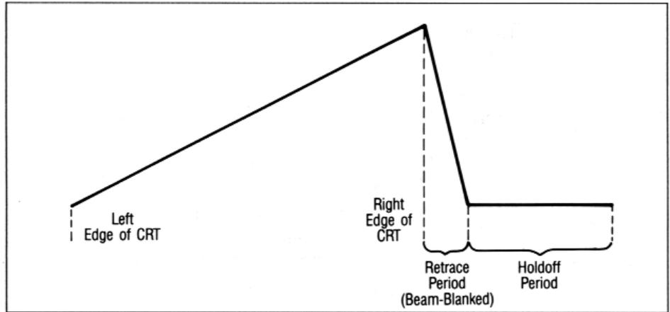
**Fig. 15. Sweep waveform.**
