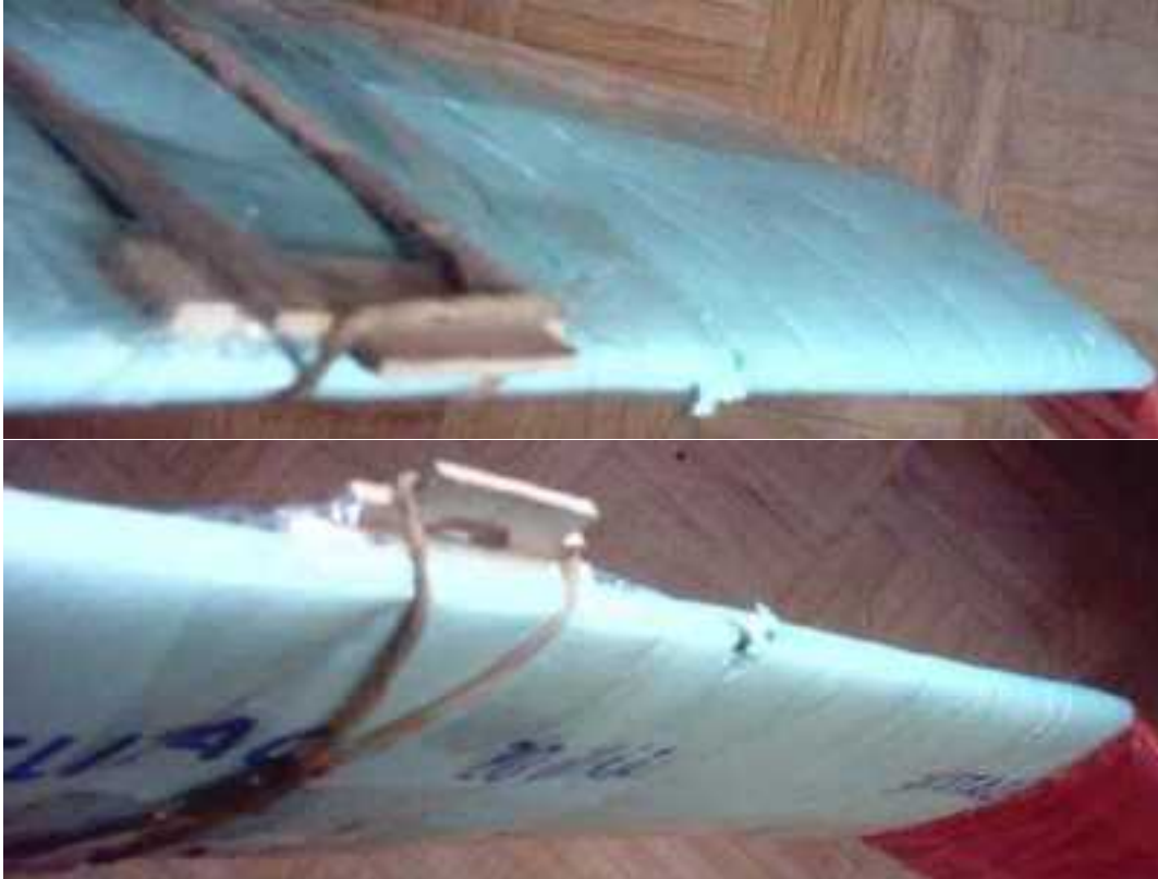
Trittschallfolie macht torsionsfester und wiegt 80g/m 2 .
