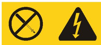
يوجد تيار كهربائي في منتهى الخطورة بداخل المكونات التي تم وضع هذه العلامة عليها. لا توجد أجزاء يمكن صيانتها داخل هذه المكونات. اذا كنت تشك في وجود مشكلة مع أي جزء من تلك الاجزاء، اتصل بفني الخدمة.
