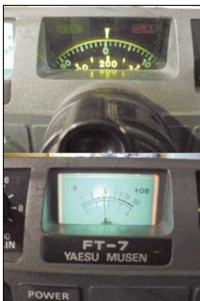
Foto 3 - La scala di sintonia e lo Smeter.
