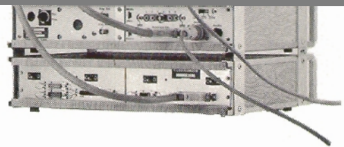
4 réglettes permettent de rendre les périphériques solidaires du générateur employé (les cordons de raccordement sont fournis avec chaque périphérique).
