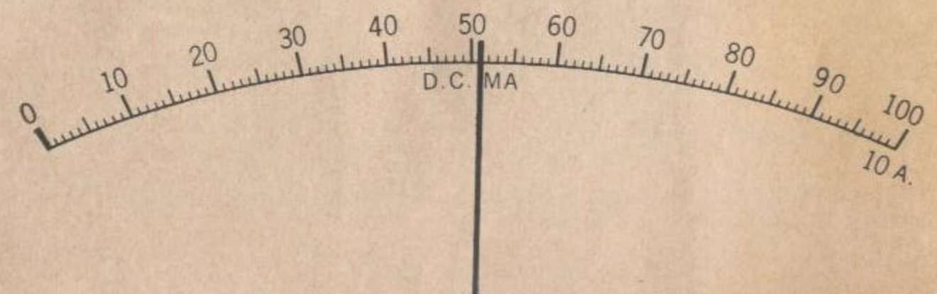
Figure 25—10A. D.C. Scale
