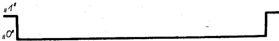
Przebieg napięcia na wyjściu komparatora
